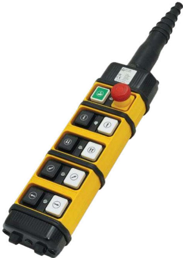
Hängetaster für die Hilfssteuerung, widerstandsfähig und zuverlässig, für die Schwerindustrie entwickelt. Modulares Gehäuse mit in zwei parallelen Reihen angeordneten Stellgliedern, um entgegengesetzte Funktionen zu koppeln und geringe Abmessungen zu gewährleisten.
