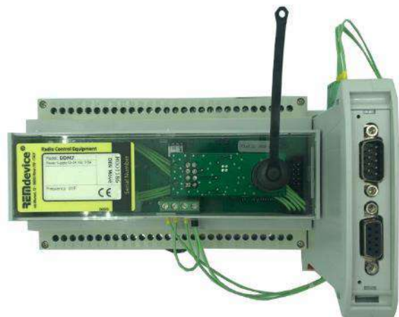
Spezieller Profibus-DP Empfänger zum Einbau in den Schaltschrank und mit zusätzlicher Kabelanbindung:
